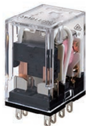
コイルテープ ピンク=AC電圧
