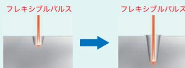
フレキシブルパルス(分割されたパルス)レーザにより1パルス当たりの出力アップを実現。さらに連続的な照射により、深さ方向へも熱が伝わり深彫り形状が可能となります。
