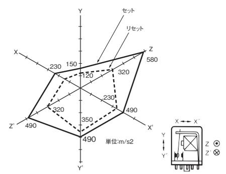
測定: 3軸6方向にリセット、セット状態(無励磁)で各3回衝撃を加え接点の誤動作を生じる値を測定。
