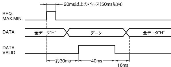
REQ信号の立ち上がり約30msでデータが確立し、DATA VALID信号が出ます。
