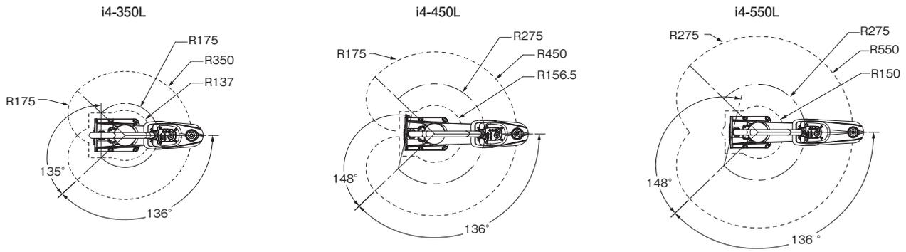
注. ロボットの構成、タイプ、ケーブルの構成により、ロボット後方のリーチ長に異なる制限が発生する場合があります。
