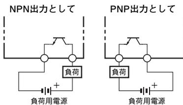
・出力トランジスタのコレクタに接続してあるダイオードは誘導負荷使用時の逆起電圧吸収用としてご利用ください。
