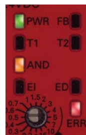
論理接続の異常
