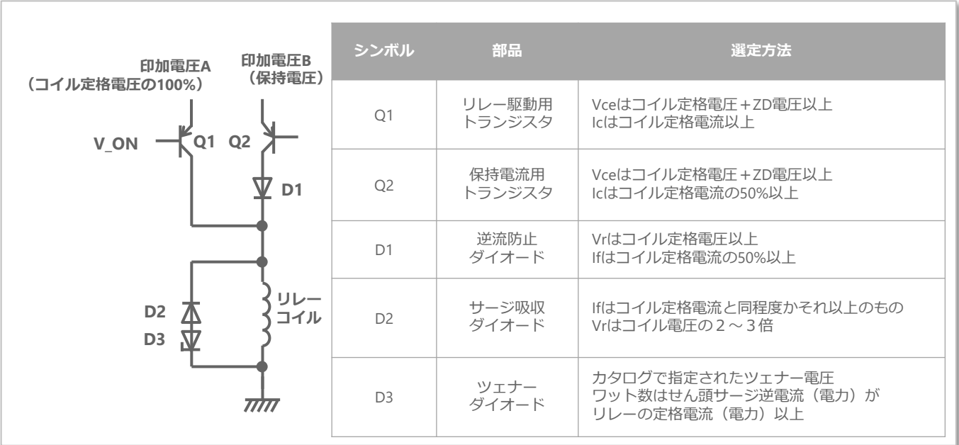
[図23:スイッチによる推奨保持電圧回路例、周辺部品の選定方法]
