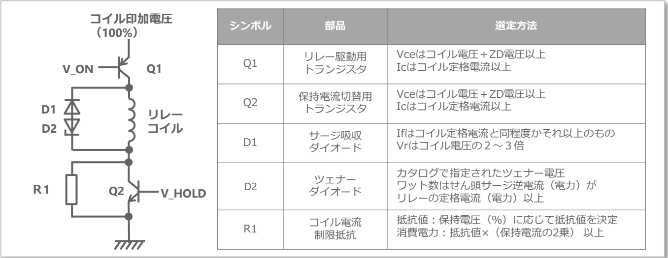
[図21:スイッチによる推奨保持電圧回路例、周辺部品の選定方法]
