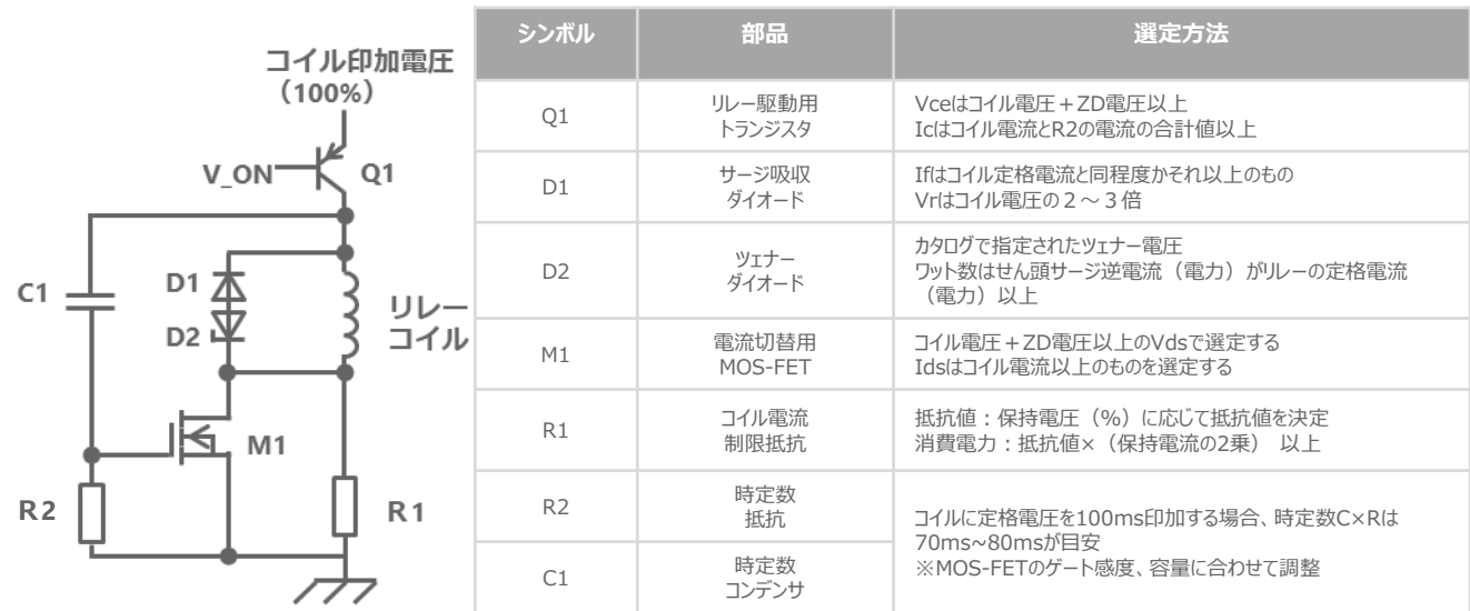
図15:保持電圧CR回路例、周辺部品の選定方法
