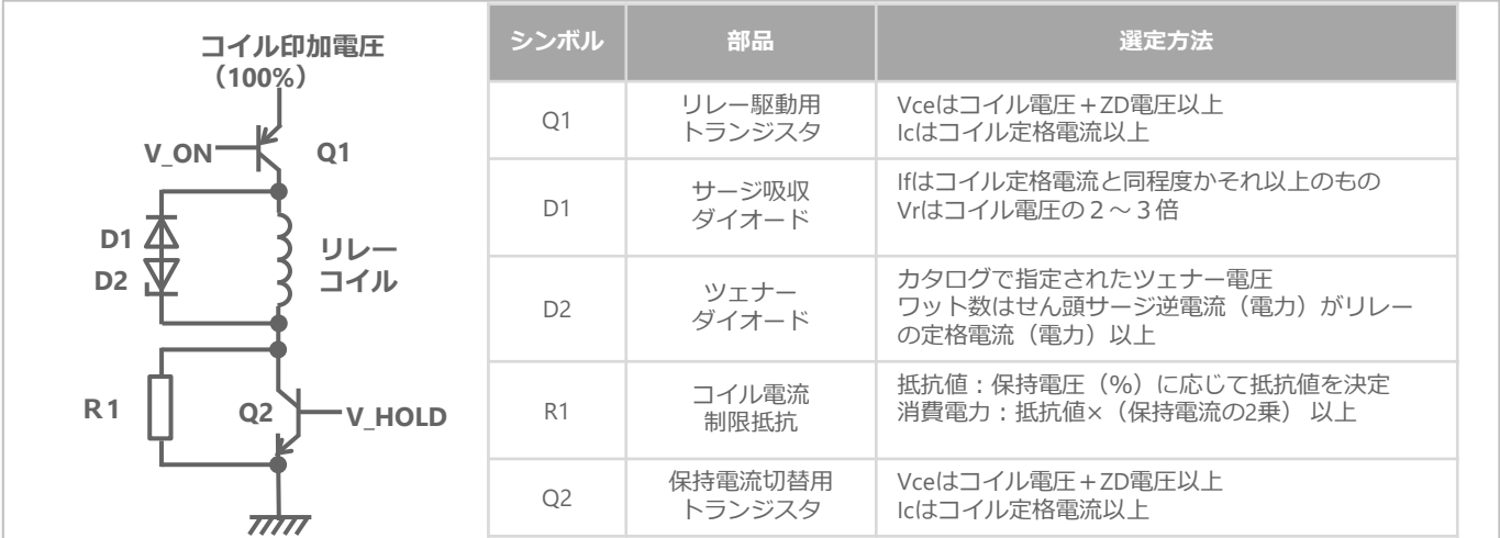
図17：スイッチによる保持電圧回路例、周辺部品の選定方法
