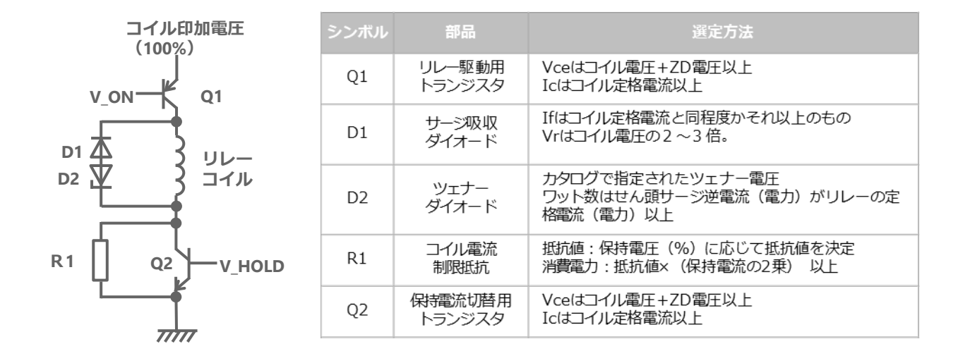
図18：スイッチによる保持電圧回路例、周辺部品の選定方法
