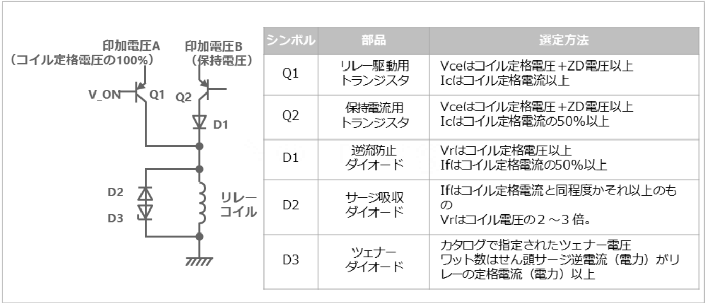
図20：スイッチによる推奨保持電圧回路例、周辺部品の選定方法
