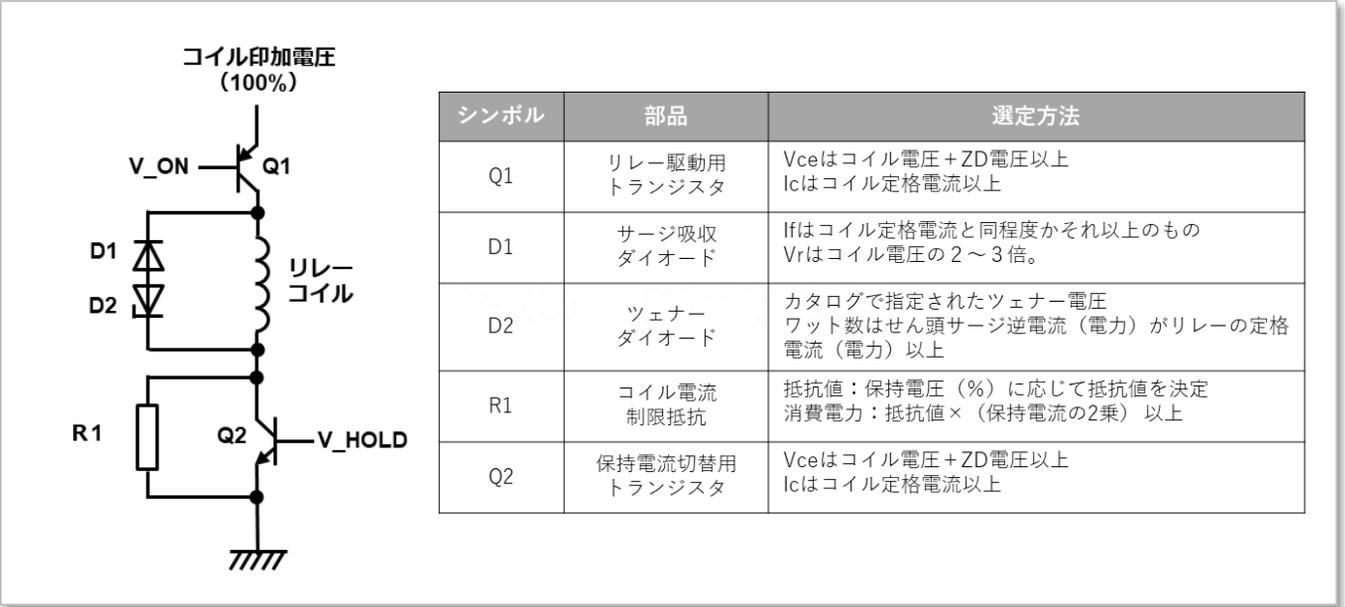
図10.スイッチによる保持電圧回路図例、周辺部品の選定方法
