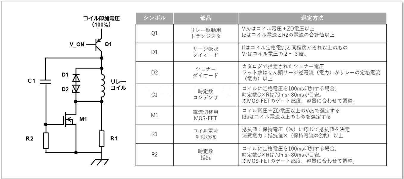
図8:保持電圧CR回路例、周辺部品の選定方法
