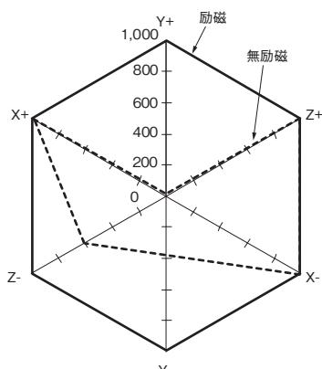
測定： 3軸6方向に各3回、衝撃を加え接点の誤動作を生じる値を測定。ただし、励磁電圧は保持電圧定格内とする。
