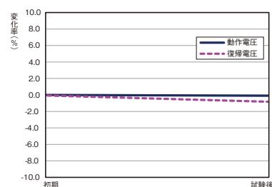
490m/s<sup>2</sup> の衝撃を試料(無励磁)の 3 軸 6 方向に各 3 回加えられた後、各特性を測定する。変化率(%)の値は試料の平均値です。
