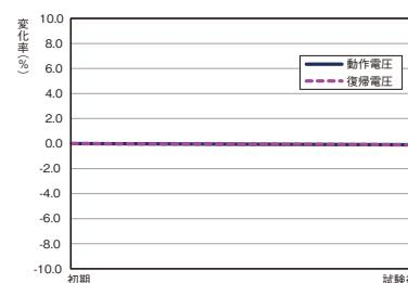
490m/s<sup>2</sup> の衝撃を試料(無励磁)の 3 軸 6 方向に各 3 回加えた後、各特性を測定する。変化率(%)の値は試料の平均値です。
