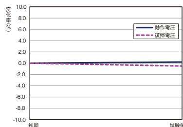
周波数 33Hz 45m/s<sup>2</sup> の振動を、試料(無励磁)の上下方向 4h 左右、前後各 2 時間加えた後、各特性を測定する。変化率(%)の値は試料の平均値です。
