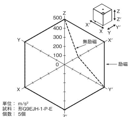
3軸6方向に励磁、無励磁で各3回衝撃を加え接点の誤動作を生じる値を測定。
