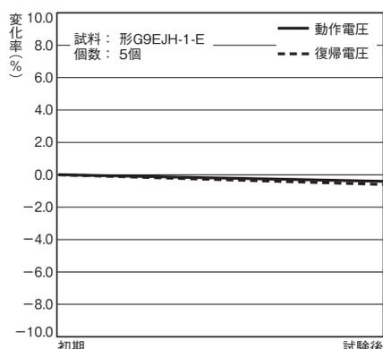
周波数10～55Hz(片振幅0.75mm)の振動を試料(無励磁)の3軸方向に2時間ずつ加えた後、各特性を測定する。変化率(%)の値は試料の平均値です。
