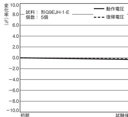
490m/s<sup>2</sup>の衝撃を試料(無励磁)の3軸方向に各3回加えた後、各特性を測定する。変化率(%)の値は試料の平均値です。
