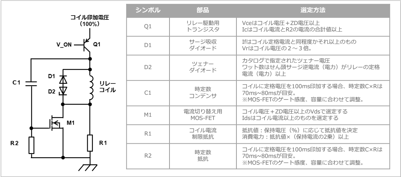
図10:保持電圧CR回路例、周辺部品の選定方法
