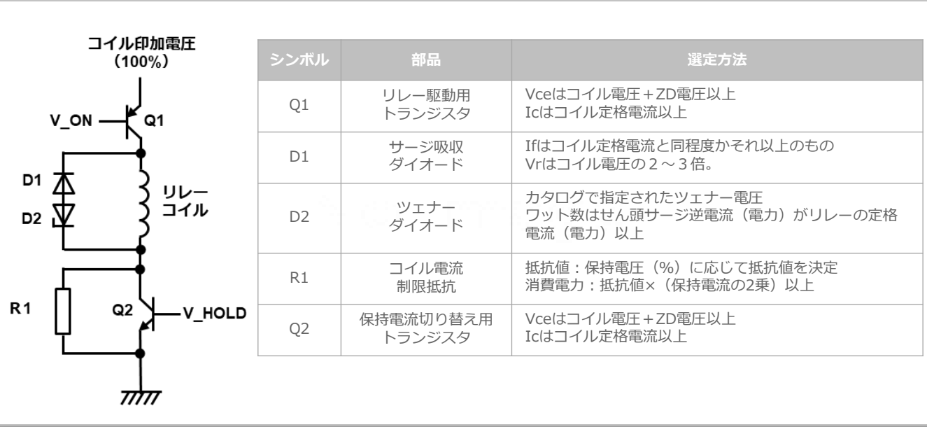
図12.スイッチによる保持電圧回路図例、周辺部品の選定方法
