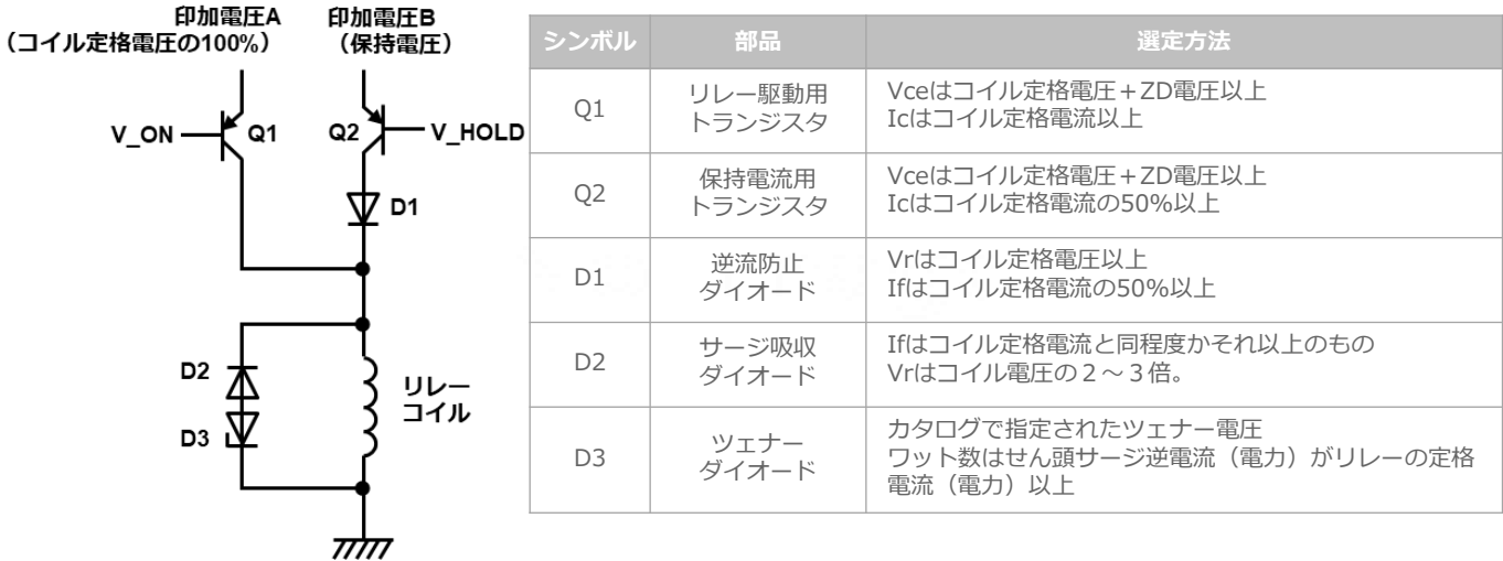
図14:スイッチによる推奨保持電圧回路例、周辺部品の選定方法
