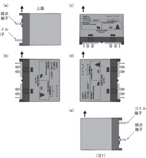
注1. 接点端子下方向の取り付け方向(e)のみ、動作電圧とコイル印加電圧が異なりますので2ページの「●操作コイル」および「●リレー動作時および動作後のコイル電圧低減(保持電圧)について」をご確認ください。
