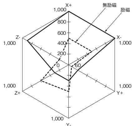
測定： 3軸6方向に各3回、衝撃を加え接点の誤動作を生じる値を測定。ただし、励磁電圧は保持電圧定格内とする。
