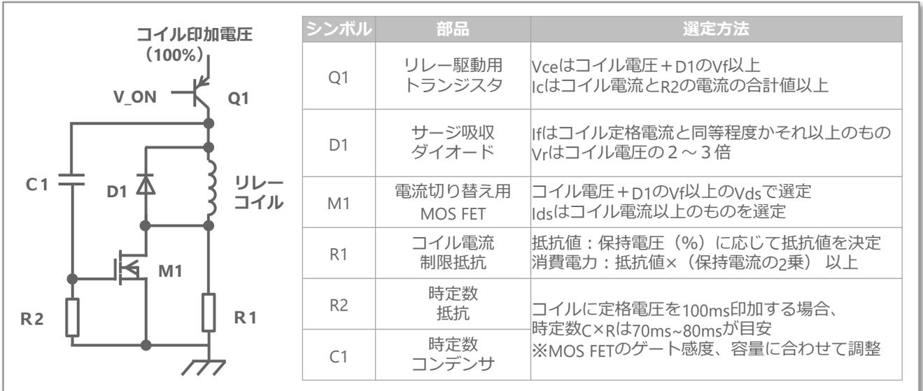
[ 図14 : 推奨保持電圧CR回路例、周辺部品の選定方法 ]
