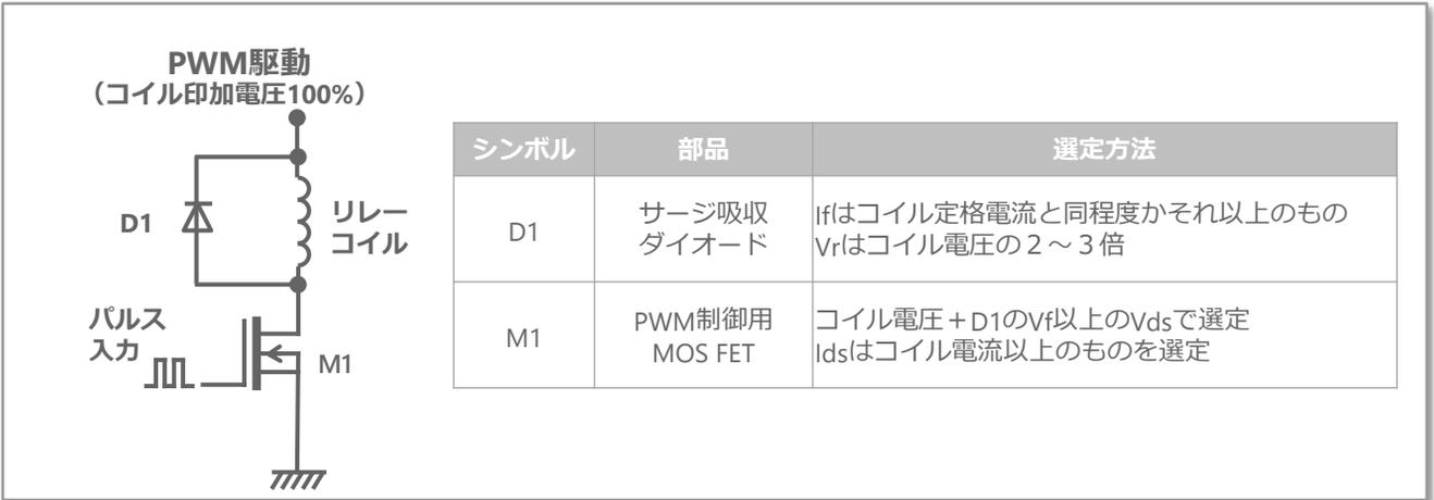
[ 図20 : 推奨PWM制御回路例、周辺部品の選定方法 ]
