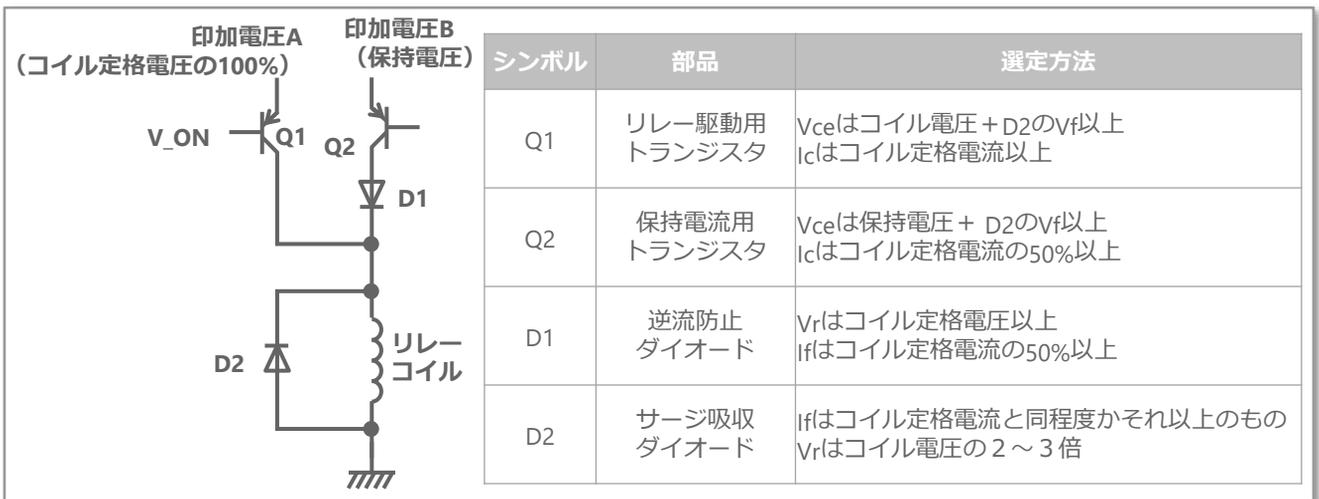
[ 図18 : スイッチによる推奨保持電圧回路例、周辺部品の選定方法 ]
