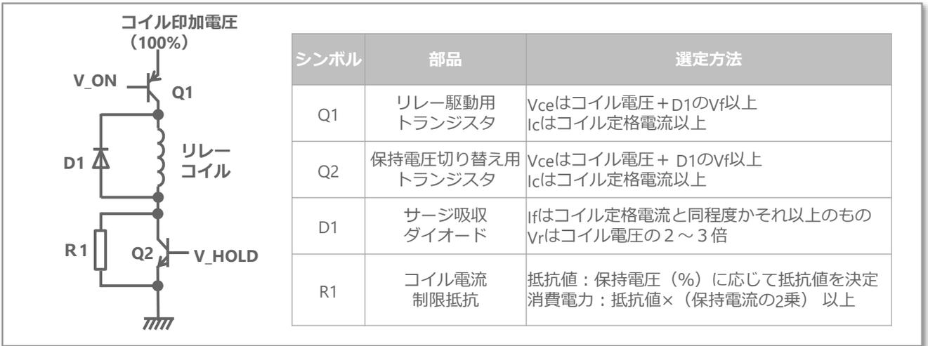
[ 図16：スイッチによる推奨保持電圧回路例、周辺部品の選定方法 ]
