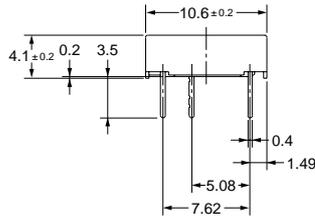
プリント基板加工寸法 (BOTTOM VIEW)
