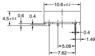
プリント基板加工寸法 (TOP VIEW)
