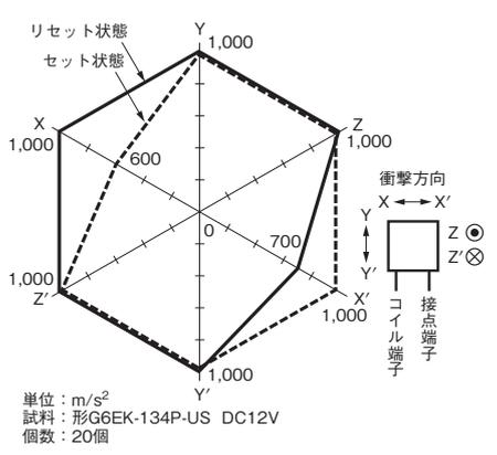
測定: 3軸6方向に無励磁で3回、励磁で3回、それぞれ衝撃を加え接点の誤動作を生じる値を測定。
