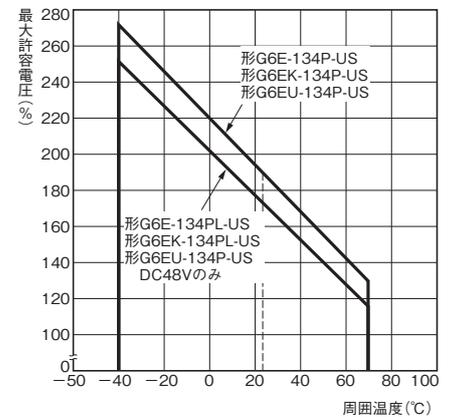
注. 最大許容電圧は、リレーコイルに印加できる電圧の最大値です。
