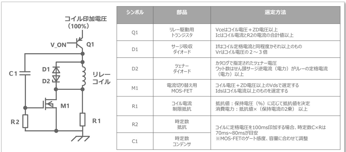
図20:保持電圧CR回路例、周辺部品の選定方法
