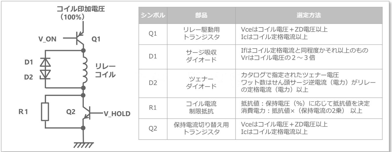
図22:スイッチによる推奨保持電圧回路例、周辺部品の選定方法
