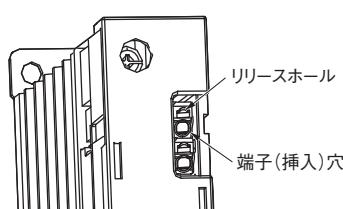
圧着棒端子(以降フェルール端子)付き電線、単線の接続方法
