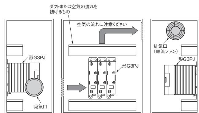
注1. 吸気口あるいは排気口がフィルタ付きの場合、目詰まりによる効率低下を防ぐために定期的な清掃を行ってください。
