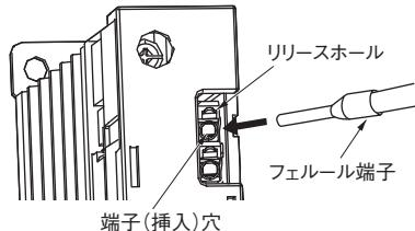
細い単線で接続しにくい場合は、より線の接続方法同様にマイナスドライバを使用してください。
