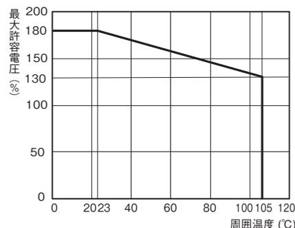
注. 最大許容電圧は、リレーコイルに印加できる電圧の最大値です。
