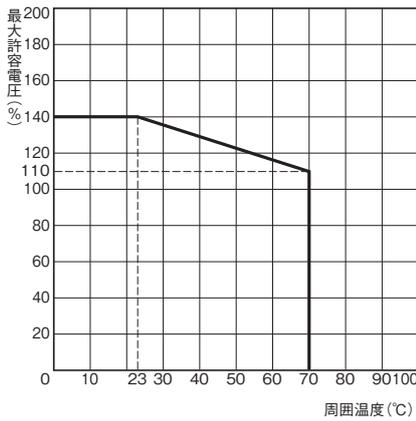
注. 最大許容電圧は、リレーコイルに印加できる電圧の最大値です。
