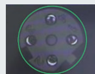
位置ずれによる穴の 見え方の違いを考慮した 良品画像を復元
