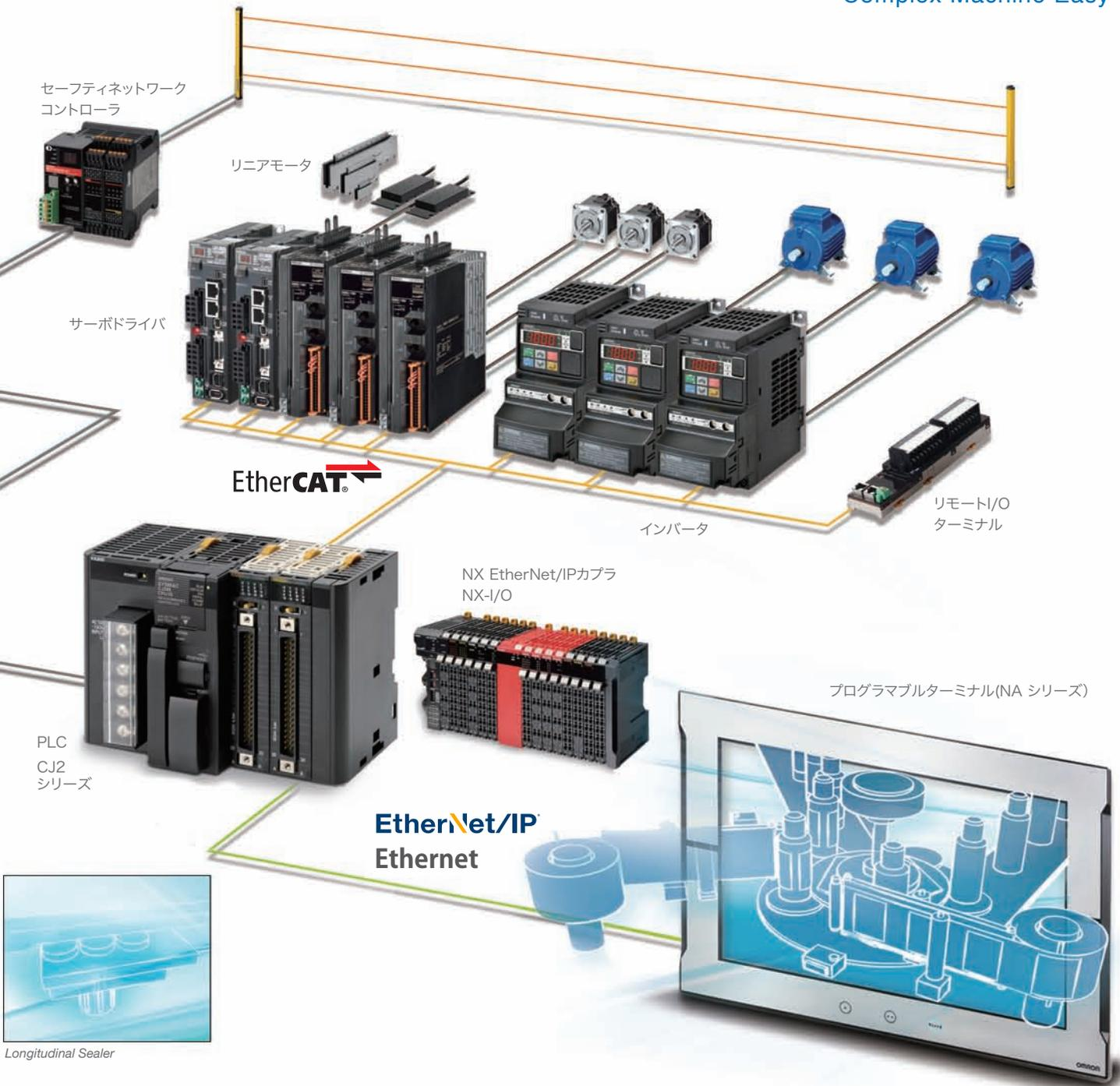
**CJ2/CS1 EtherNet/IPとNX EtherNet/IPカプラユニット**
