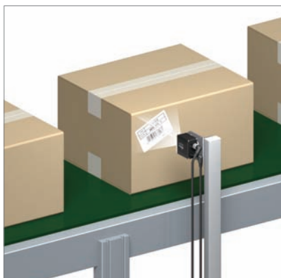
ラベル方向検査とコード・賞味期限検査
