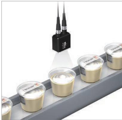
ラベルの有無検査
