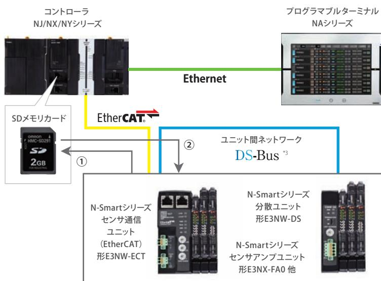
ノード毎、アンプ毎に複数種類のパラメータをバックアップできるため、表示器からリストアすべきパラメータ種別を指定することで多品種の段取り替えも効率化。
