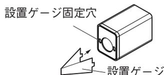
2. 設置ゲージの先端が測定対象物に軽く触れるように本体の位置をあわせませます。
