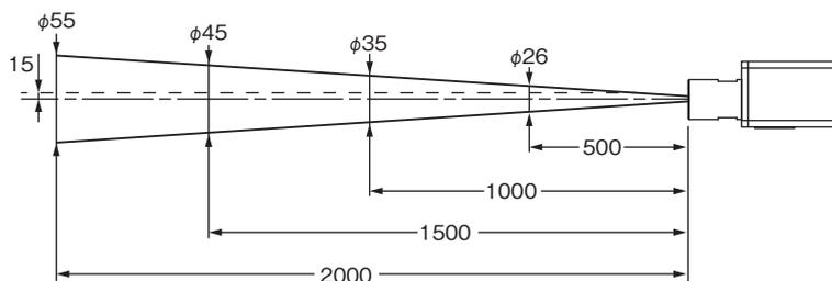
注. 上段：測定視野径、下段：距離
