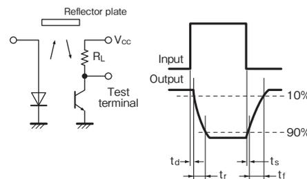
図12. 光電流測定配置図
