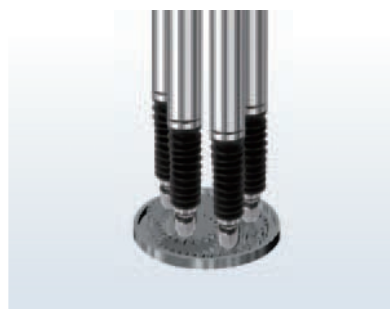
時計の歯車の組み立て高さ測定
