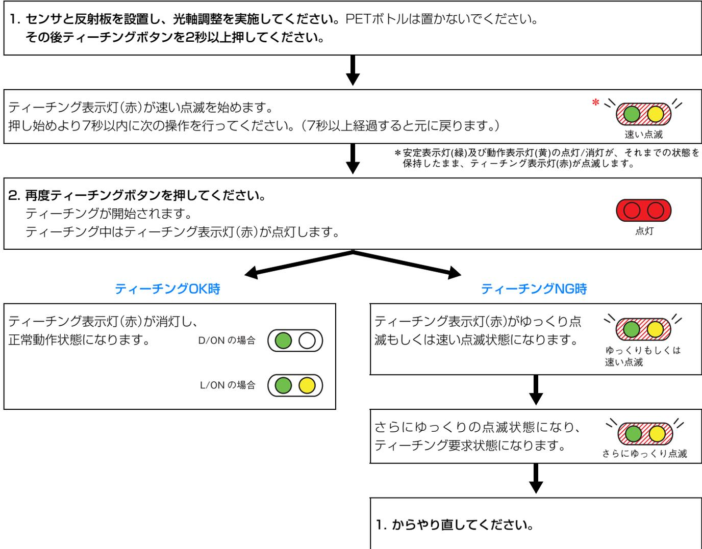
注. ティーチング中にも受光量に応じて、出力・動作表示灯・安定表示灯が変化します。
