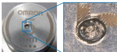
20万回の連続打撃テストを行った結果、打撃による検出面は、非貫通。絶縁破壊が起きませんでした。
