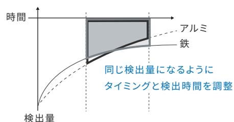
\*3. PRD(Pulse Response Detection)とは、コイルにパルス状の電流を流したときに検出物体で発生する電流の変化を検出する技術です。
