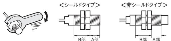
注1. ヘッド先端からの距離により許容強度が異なります。図のA部とB部での締め付け許容強度を下表に示します。(A部とはヘッド先端から下表の寸法までの範囲です。B部は図のように、ヘッド側のナットも含まれます。したがって、このナット端が少しでもA部に入る場合は、A部の強度を適用してください。)
