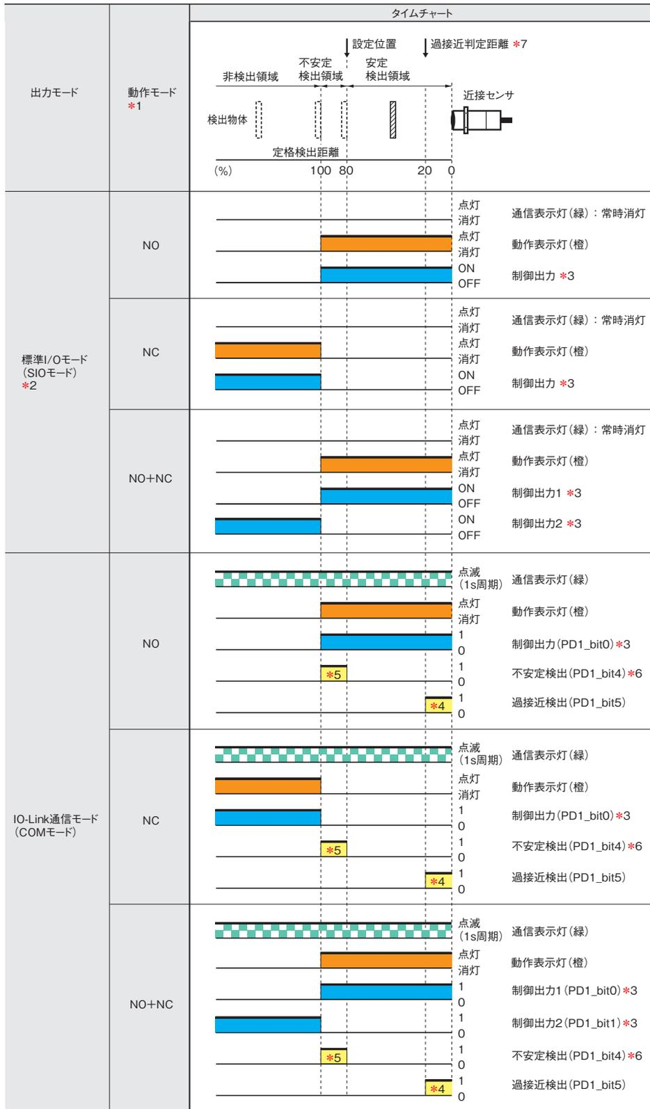
\*3. IO-Link 通信により、制御出力のタイマ機能の設定が可能です。(ONディレイ、OFFディレイ、ワンショット、ONOFFディレイの機能選択および1~16,383msのタイマ時間Tの設定が可能。)
