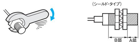
注1. ヘッド先端からの距離により許容強度が異なります。図のA部とB部での締めつけ許容強度を下表に示します。(A部とはヘッド先端から下表の寸法までの範囲です。B部は図のように、ヘッド側のナットも含まれます。したがって、このナット端が少しでもA部に入る場合は、A部の強度を適用してください。)
