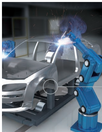
溶接する金属板の着座確認
