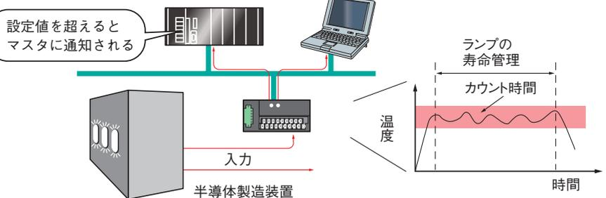
変化を繰り返す温度入力値の山または谷の部分をカウントします。温度の上昇、下降が激しい装置で、メンテナンス時期を予測できます。
