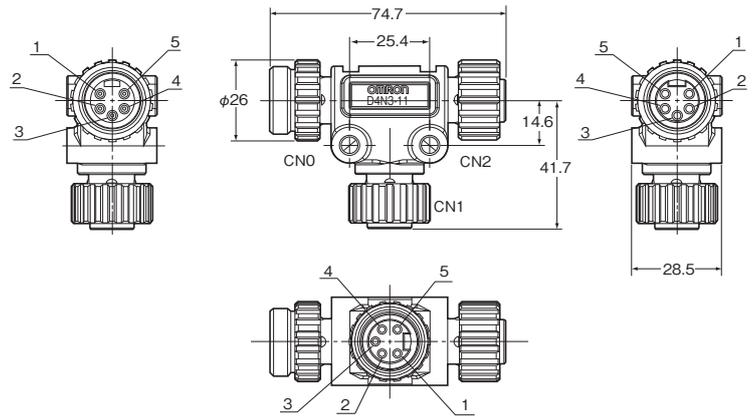
T分岐コネクタ(通信用5極細線引出しタイプ)
