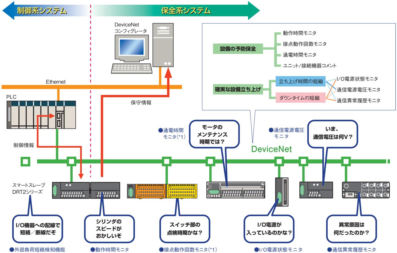
\*1：接点動作回数モニタ機能と通電時間モニタ機能は同時使用は不可。
