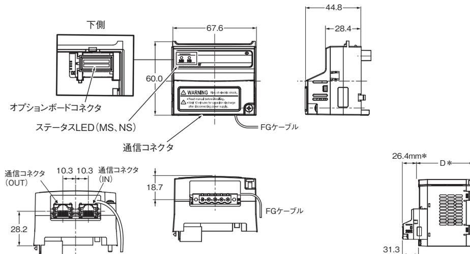
注. DeviceNet通信ユニットを取り付けた場合の全体の寸法は、インバータ本体のD寸法に26.4mmを加算してください。
