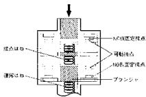
EN60947-5-1の直接開路動作認証 ⊕ (NC接点側のみ直接開路動作機能をもっています。) 溶着発生時、プランジャの押し込みにより、NC接点を開離し、回路をしゃ断します。
