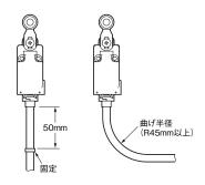
・配線時ケーブル末端部から水、油などが浸入しないように してください。
