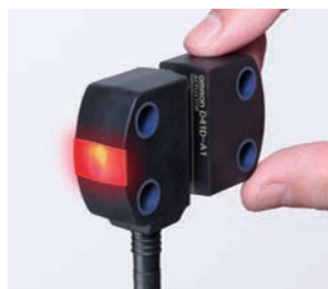
②アクチュエータを近づけると ティーチング開始。その後電源 OFF。*1
