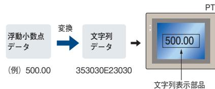
計測器などからシリアル通信で読み出したASCII(文字列)データを演算に使用する場合、CS1ならそれを浮動小数点データに簡単に変換できます。
