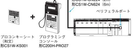
形CS1W-CN224 (2m)<br>形CS1W-CN624 (6m)<br>ペリフェラルポート<br>プロコンキーシート (和文) 形CS1W-KS001<br>プログラミングコンソール 形C200H-PRO27 | 形C200H-PRO27 *<br>(形C200H-PRO27-E) | 64,000      |
