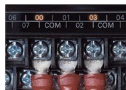
端子台配列に対応した入出力表示LED配置により、配線不具合箇所がすぐに特定できます。
