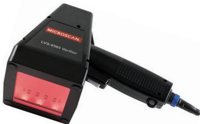
LVS-9585は、ISO/IEC、ANSI、GS1規格準拠のバーコード検証をオフラインで行う高性能の手持ち式ソリューションです。500万画素の高解像度カメラを搭載し、最大で幅76.19mm、高さ57.15mmのバーコード(1Dコード)および2次元コード(2Dコード)を読み取り、分析します。最大で44mm×44mmの1次元および2次元のダイレクトパーツマーキング(DPM)も、MIL-STD-130、ISO、GS1規格に照らして検証することが可能です。
