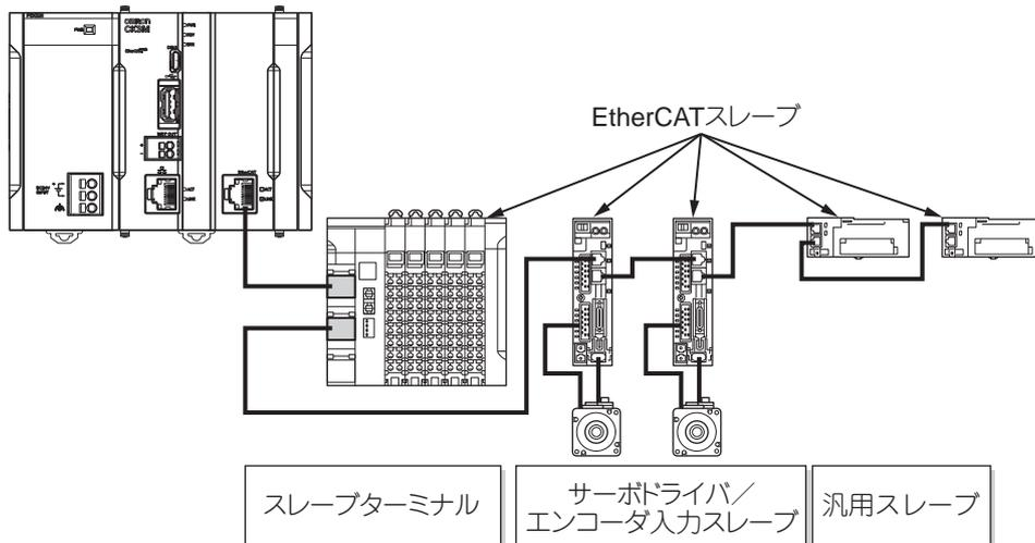
EtherCATはCK□MシリーズCPUユニットのサーボサイクルと同期されます。これにより、スレーブターミナルなどのIOデータがサーボサイクルに同期して取得できます。
