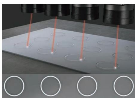
指令が同期しレーザON/OFFのタイミングも同期するため、同一形状の製品が加工可能。
