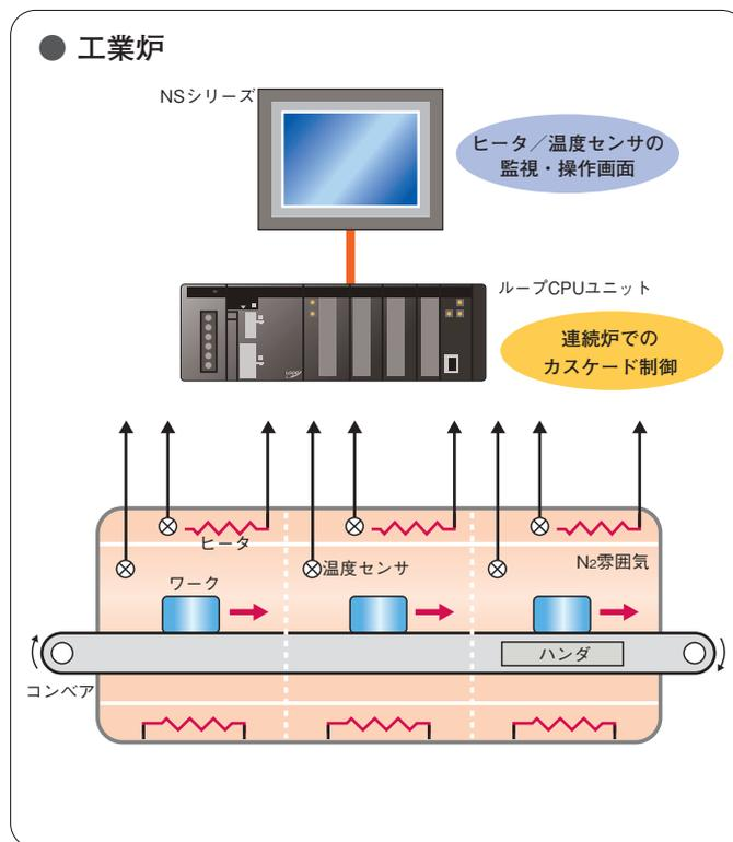
● 多点の均一温度制御を実現した 傾斜温度制御 ※形CJ1G-CPU45P-GTCのみ
