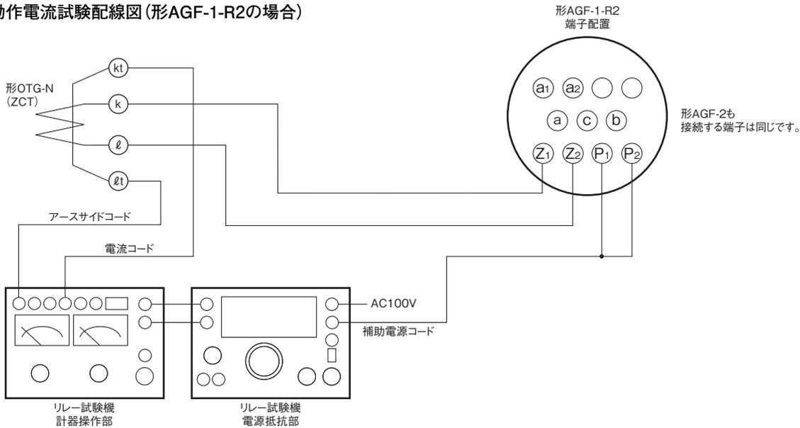
動作時間試験配線図 (形AGF-1-R2の場合)
