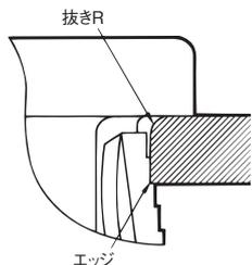
パネル加工時の抜きRがスイッチ操作面側となるようにしてください。
