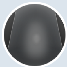
コーティングのムラ欠陥
