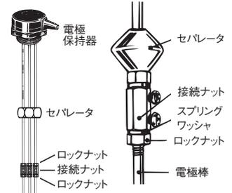
注. セパレータを使用する場合、接続ナットのビスの向きが他の電極棒接続ナットのビスにぶつからないよう取り付けの向きに注意して取りつけてください。
